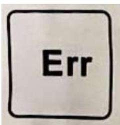
Cuando aparece este mensaje durante el pesaje, significa que la carga actual excede el peso máximo de este producto. Retire el objeto inmediatamente para evitar daños al cuerpo de la báscula.
